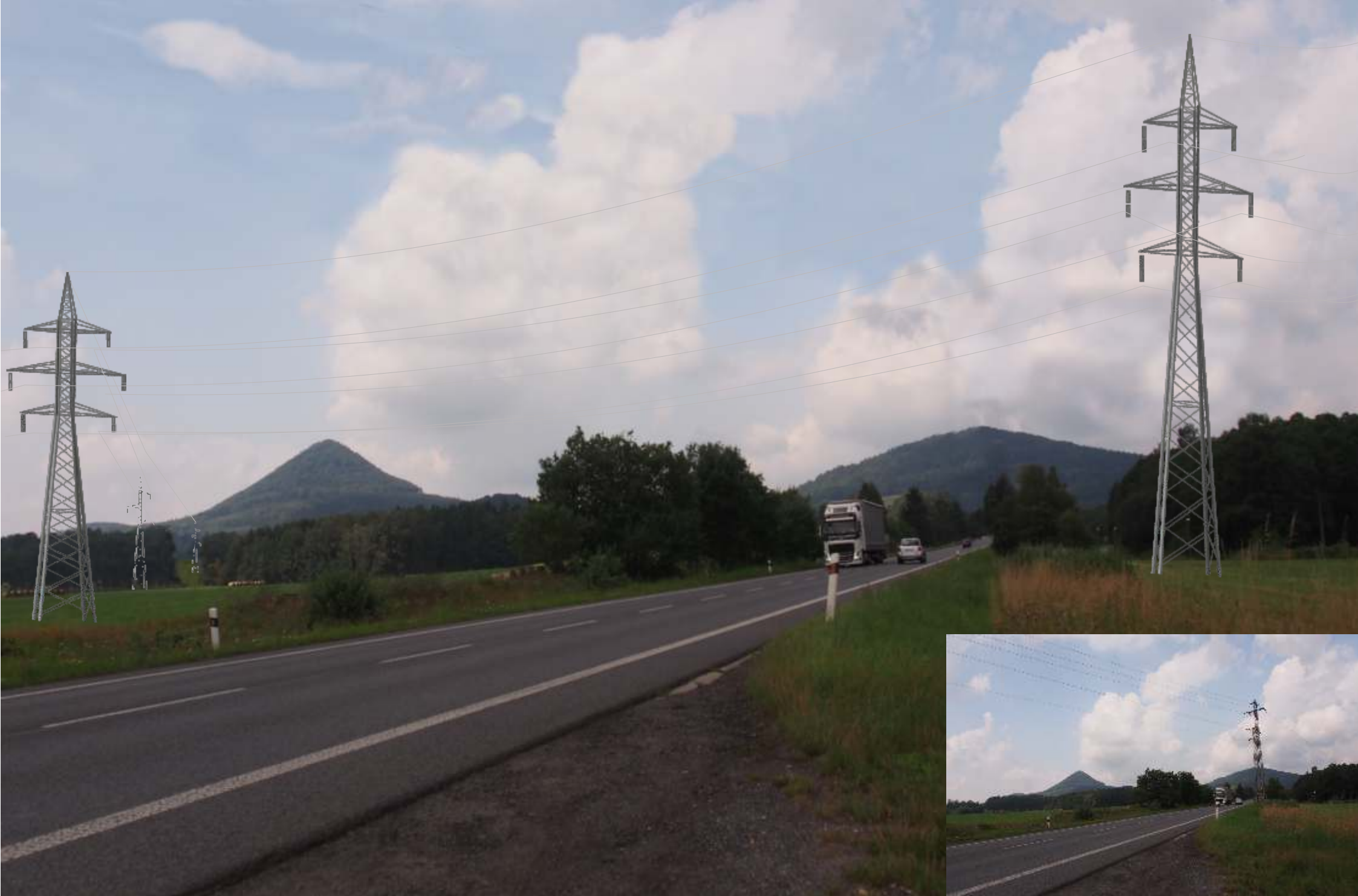
Pohled od Cvikova na Svor, využívané stožáry „Soudek” s dvojpotahem pro 110 kV a 35 kV
