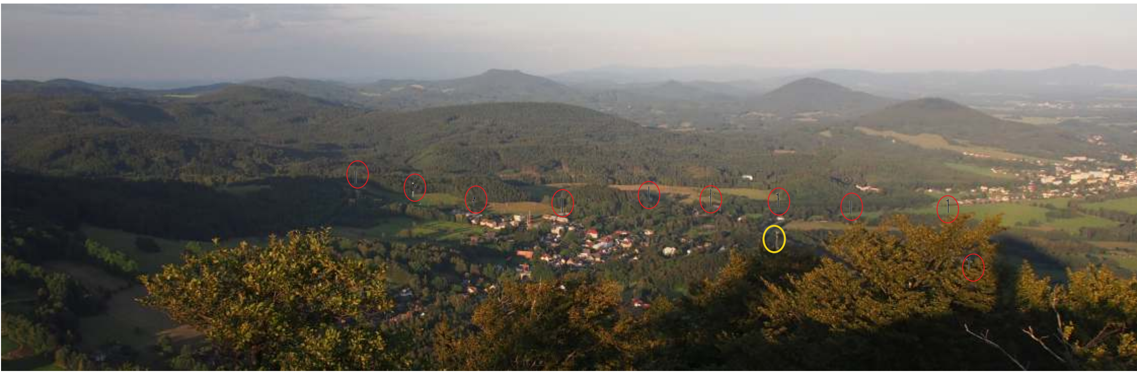
Vizualizace vedení VVN 110 kV : Stožáry jsou prakticky nezřetelné. Vrchní vizualizace používá typ „Soudek“, spodní typ „hraněný“. Hraněné stožáry jsou díky své hmotě a odleskům poněkud zřetelnější - viz referenční telekomunikační stožár vyznačený žlutě.
