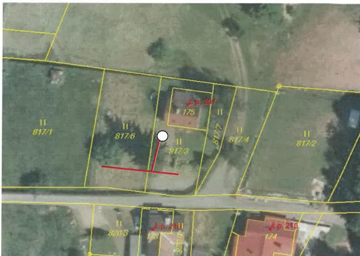
**Obr.č. 46. Návrh umístění vsakovacího prvku**
