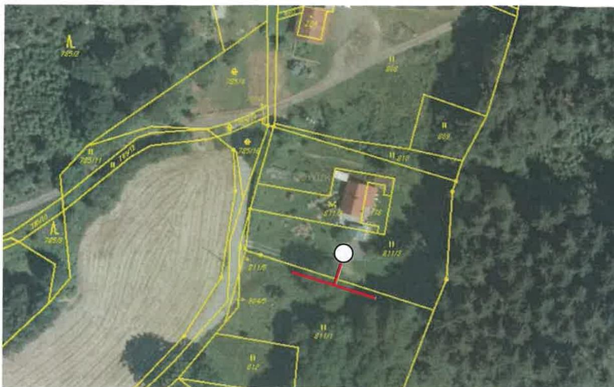
Obr.č. 63. Návrh umístění vsakovacího prvku
