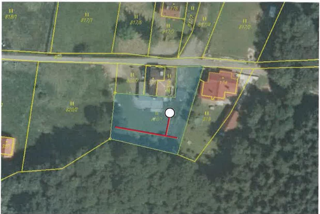
Obr.č. 37. Návrh umístění vsakovacího prvku
