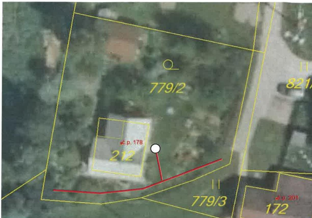
Obr.č. 25. Návrh umístění vsakovacího prvku
