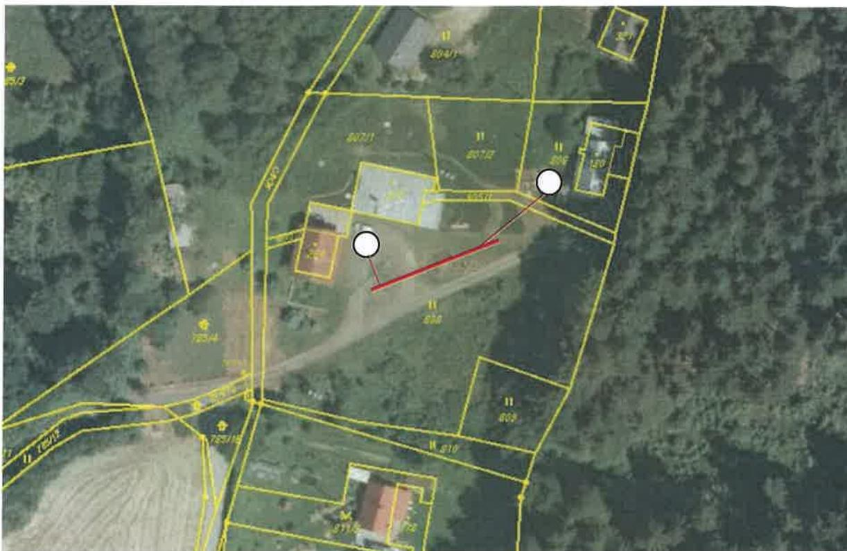
Obr.č. 67. Návrh umístění vsakovacího prvku
